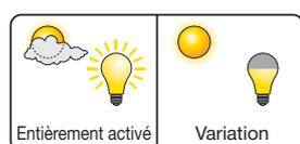
**La détection de la lumière naturelle entrante** diminue l'intensité de l'éclairage artificiel lorsque la lumière naturelle est suffisante pour éclairer l'espace.
