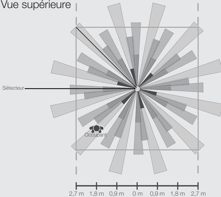
Tableau de couverture des détecteurs montés au plafond (pour un détecteur monté au centre de la pièce)
